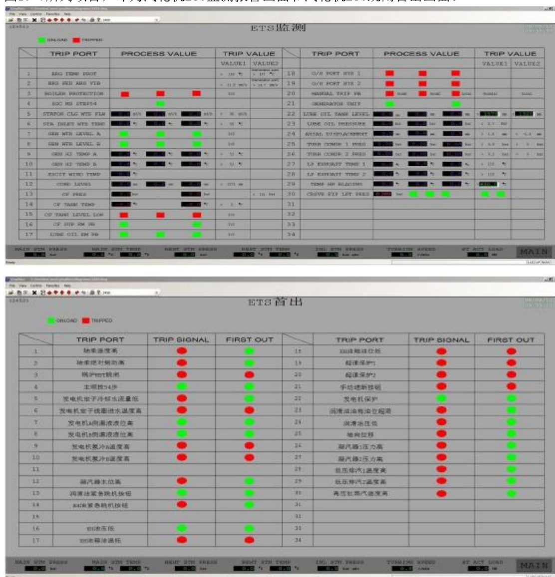
图 19-7 T3000 汽轮机保护监测及跳闸首出
