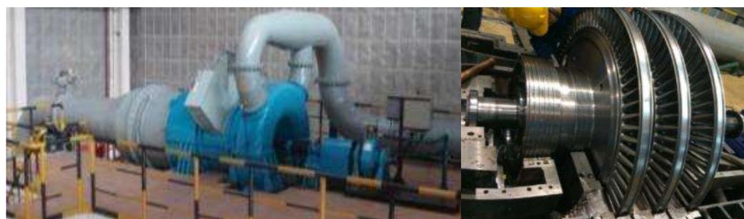
(a) 多级空气透平平台 (b) 多级空气透平试验件安装
