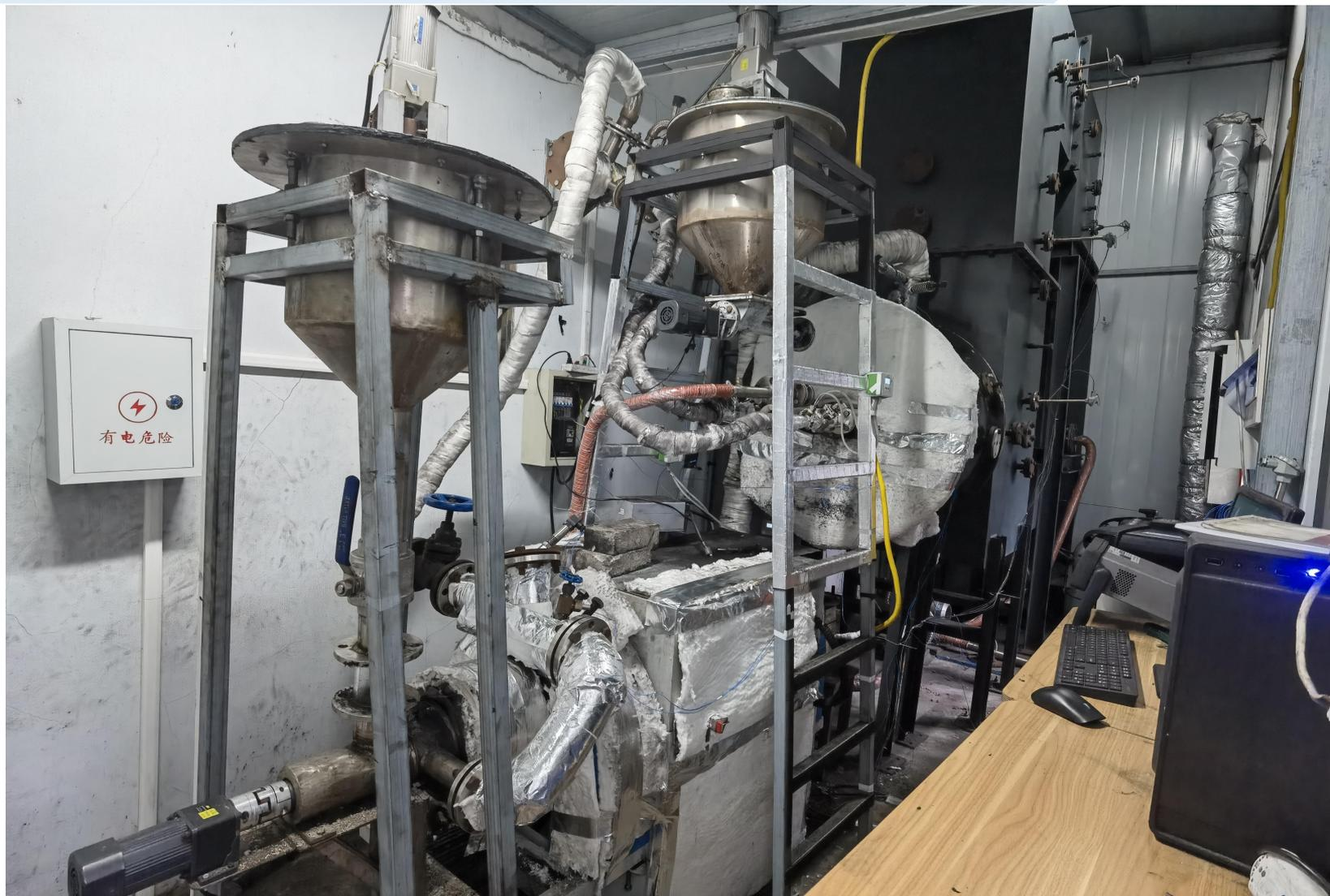
图1 0.1 MW燃煤耦合垃圾焚烧中试实验台
