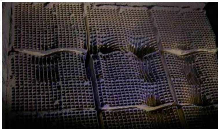
图 6 催化剂吹损照片
