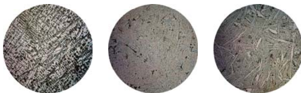
亚共晶 白口铸铁 P + Fe_3C_{II} + Ld'
