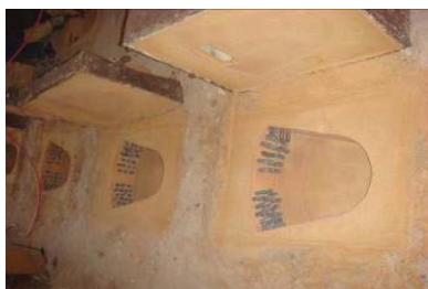
图5-1. 钉入硬质合金柱
