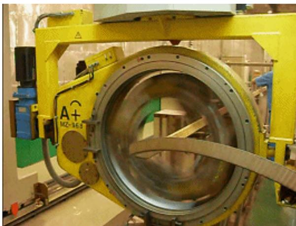
定子线圈绝缘云母带自动叠包，替代人工叠包，提高定子线圈绝缘可靠性
