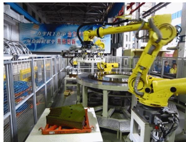
定子铁心机器人智能叠装替代人工叠装，提高叠装精度，提升铁心压装性能
