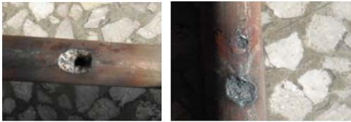
不锈钢管采用碳钢管夹固定接触产生化学腐蚀
