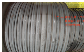
图2 高中压转子端部
