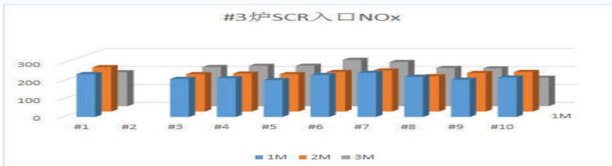
分析：#3 炉 SCR 入口 NO<sub>x</sub> C.V 值为 9.15%，进口氮氧化物浓度较均匀。
