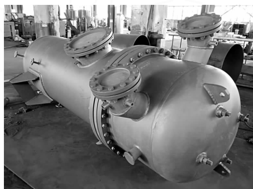
图1 汽封加热器、冷却器及轴封加热器
