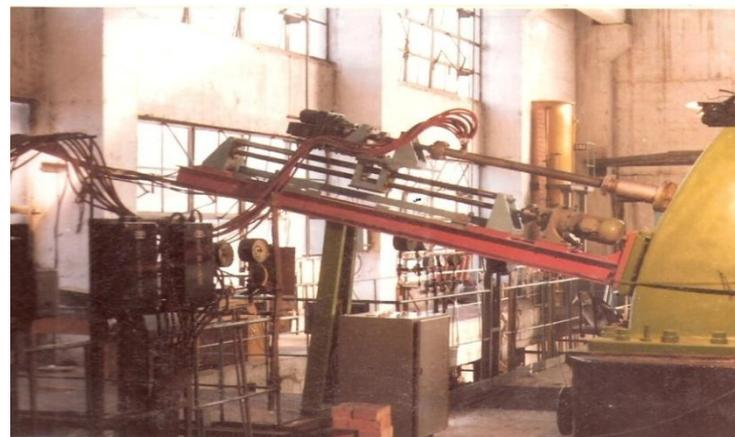
在电厂机组上实测汽轮机末级流场
