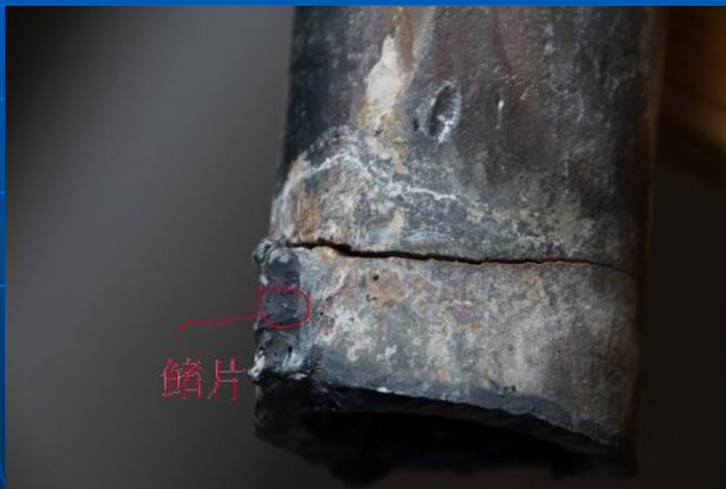
应力集中产生的裂纹
