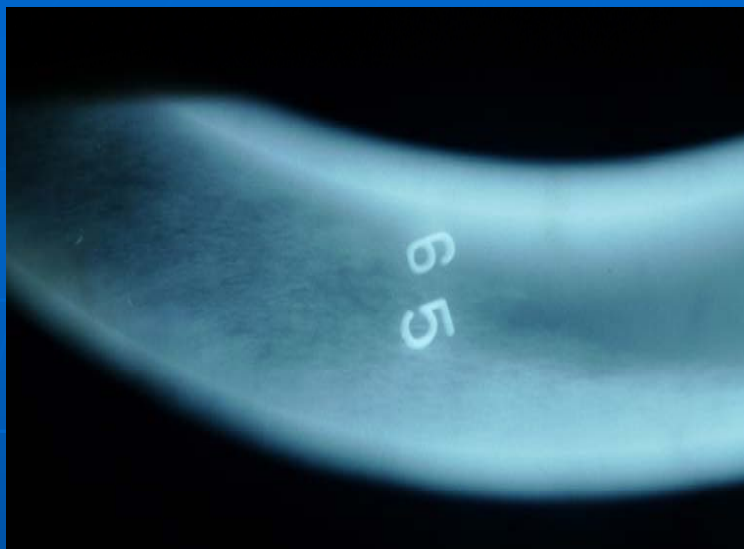
TP347H材料氧化皮脱落，并在出口弯头处堆积
