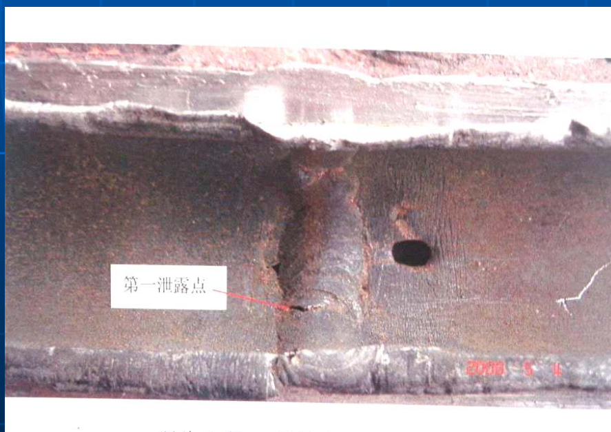
焊缝砂眼缺陷
