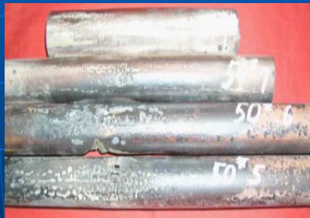
锅炉过热器管子高温腐蚀 外观形貌-腐蚀坑
