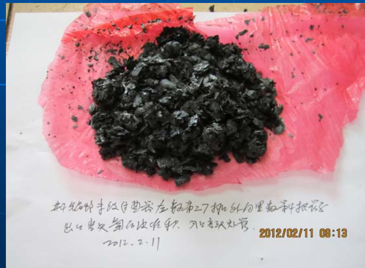
钢研102材料管子内氧化皮脱落
