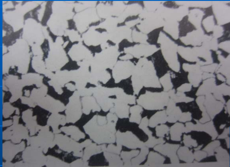
锅炉水冷壁管子原始微观组织图（20G）
