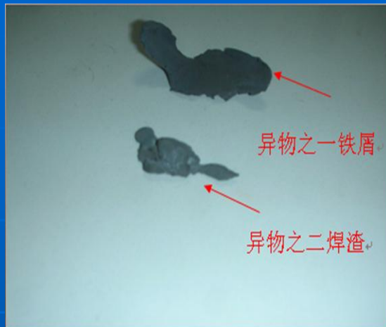
屏式过热器联箱内取出的异物
