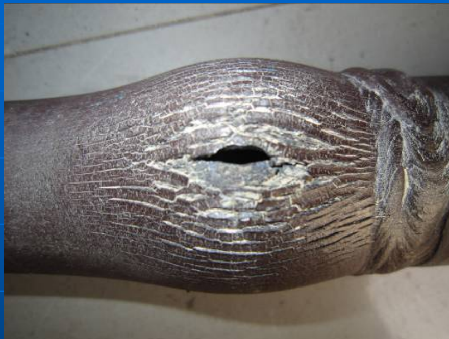
末级过热器 (T91) 爆管宏观形貌
