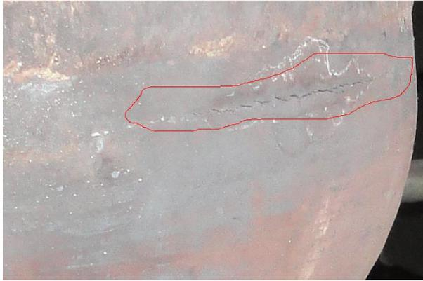
图 1：疏水罐外部泄漏部位裂纹
