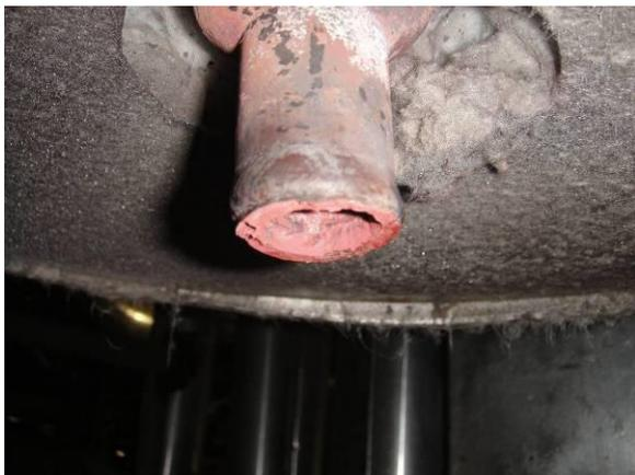
图 3：疏水罐底部放水点焊口断裂
