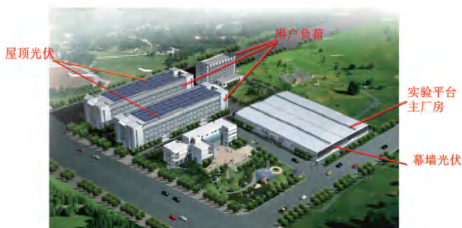
图 多能源互补分布式能源微网系统集成
