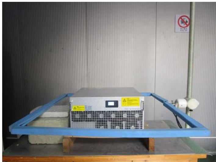
工频磁场抗扰度试验布置图
