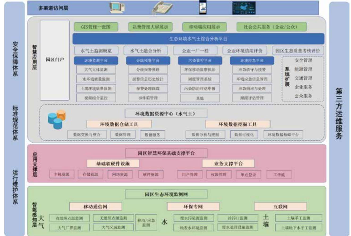
园区环保监测平台可以简化应用到小范围的水质和空气监测，在布设水质和空气监测站后，通过 HJ212 协议采集数据，平台对数据进行解析、预警和展示，用户可以通过 APP 端随时查看水质数据、空气数据、告警数据，并对告警进行处理。
