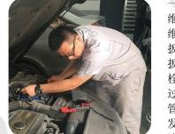
理念贯彻到每一位汽车维修技师的车辆作业中。维修技师配备标准化力矩扳手使用，定期送检力矩扳手检测，以保证紧固螺栓力矩的精确。采用走动过程检验方式及三检制度管控车辆维修作业，一经发现维修技师未按照标准流程作业，责令其重新按照标准流程整改，财务做好借还和归还的登记工作，3、商品车离店必须是在该车所有款项全部结清后，由财务销项向客户开具《江苏舜华德汽车销售有限公司放车证》，销售部门将放车证交于仓库处领取工具包。
