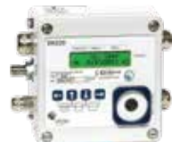
EK220 体积修正仪 最大测量绝对压力80bar 电池供电不低于5年 数字信号输入、输出 RS232/RS485/RS422串行接口
