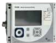
EK220 体积修正仪 最大测量绝对压力80bar 电池供电不低于5年 数字信号输入、输出 RS232/RS485/RS422串行接口
