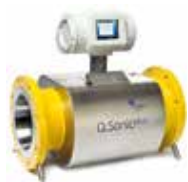
Q. Sonic plus 超声波流量计 口径: DN80-DN1400 压力等级: ANSI1150-ANSI2500 工况流量: 10-143000 m 3 /h 精度: 0.5% 声道数: 6
