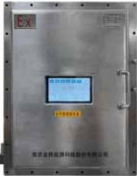
KSP-02天然气硫化氢分析仪是由南京金昇能源科技自主研发的新一代硫化氢分析仪,基于紫外吸收光谱气体分析技术,可用于测量过程气中硫化氢含量。光源采用闪烁氙灯,寿命长,稳定性好。气室采用光程反射气室,灵敏度高,吸收信号强,测量精度高;光谱仪采用高精度狭缝、全息凹面光栅、线性CCD传感器,紫外波段光谱响应快,波长准确度高,分辨率好,抗干扰能力强;采用独特算法,可实现超低量程的气体测量。
