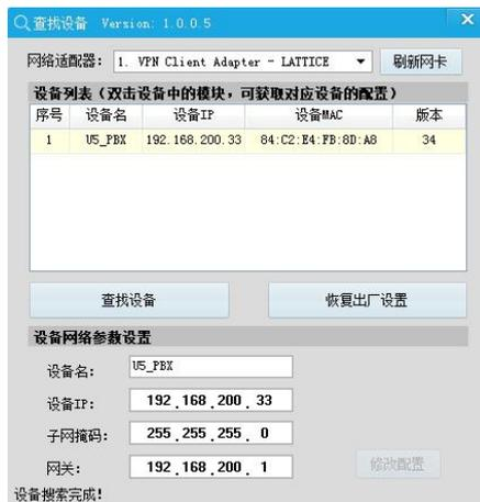
⑥将电脑的 IP 地址设为与修改主机 IP 地址后同一网段 IP 地址（接上例子，则须修改为 192.168.200.X，子网掩码 255.255.255.0, 网关 192.168.200.1）。
