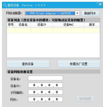
⑤点击“查找设备”后，在查找栏会发现对应的设备名、设备 IP 和设备 MAC 地址，双击修改设备 IP 地址以及相关参数（例如修改为 192.168.200.33, 子网掩码 255.255.255.0, 网关 192.168.200.1），修改时注意请勿与其他机器 IP 地址重复！
