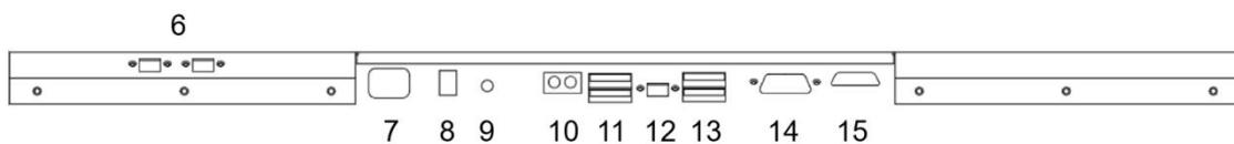
6. RJ45接口x2个, 用于连接IP话机/模拟话机
