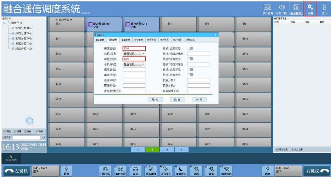
4. **键值配置**：点击右上角菜单栏“参数”，弹出“系统参数”窗口，点击“键值参数”。选择对应“键号”后，“名称”可填入中/英文名，“类型”可选择相应的话机类型，“键值”填入对应的分机号码，点击保存如下图所示。
