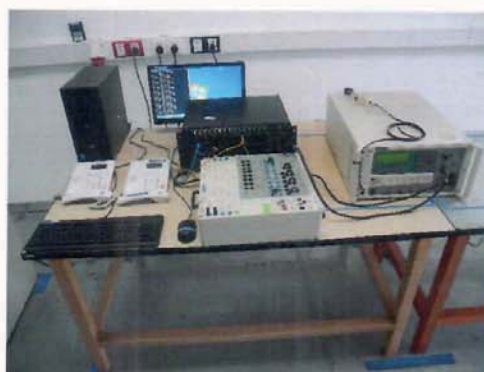
电话口雷击试验布置图
