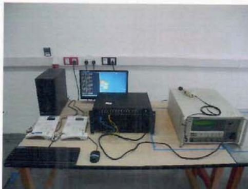
电源端子雷击试验布置图
