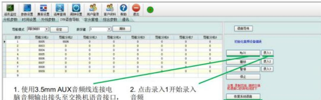
1. 使用3.5mm AUX音频线连接电脑音频输出接头至交换机语音接口，点击Mp31选择需要录入交换机的音频文件
