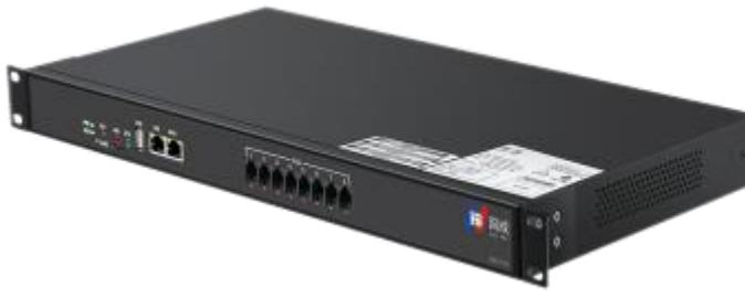
铁壳19寸1U标准机架式语音通信设备，设备采用高速、稳定、扩展性强的X86构架、双核双线程1.83GHz独立CPU、16GB内存、90并发、SIP分机≥128、SIP中继≥128、主控板接口≥1、分控板接口≥1、电源板接口≥1、RJ11接口≥8、WAN≥1、LAN≥1、USB≥1、TF存储卡槽≥1、MIC音频输入接口≥1、SPK音频输出接口≥1、RST设备复位物理按键≥1、HDMI≥1、PWR运行指示灯≥1、RUN设备运行状态灯≥1。系统内置存储录音时长80000分钟(.gsm)/9000分钟(.wav)、支持系统外置USB连接存储录音、PC话务台、Web图形数字化管理界面、通话、视频、录音、电话会议、IP对讲、广播、语音叫醒、统计、下载、DID绑定等功能。
