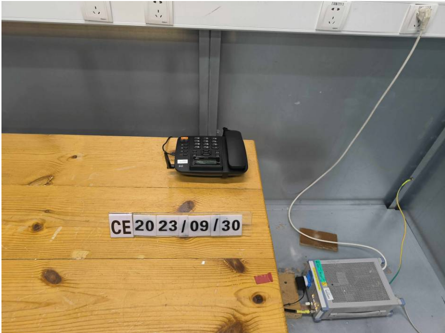
图4 传导连续骚扰试验布置
