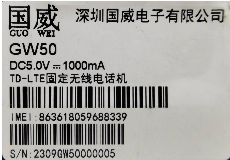
图3:被测设备铭牌
