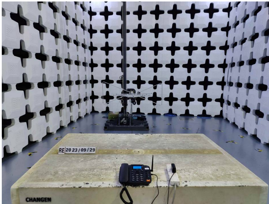
图1 辐射连续骚扰试验布置
