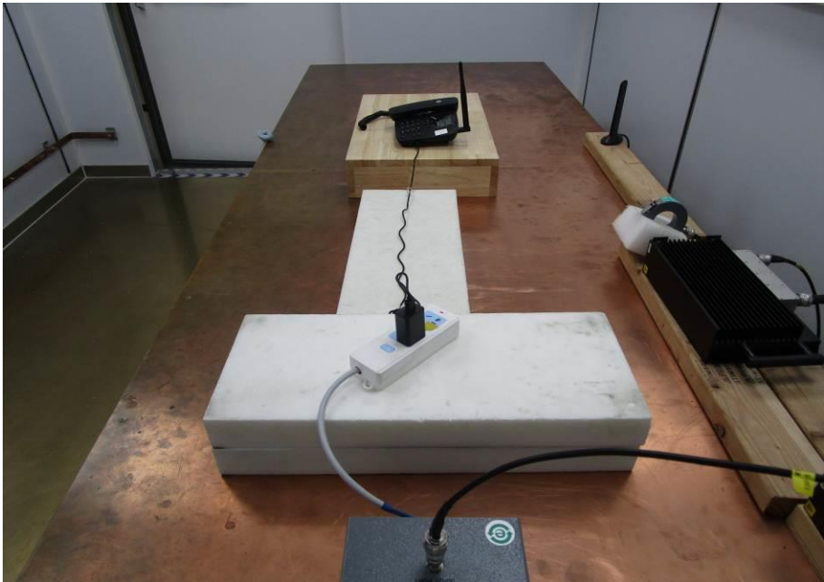
图7 射频场感应的传导骚扰抗扰度试验布置（交流电源端口）
