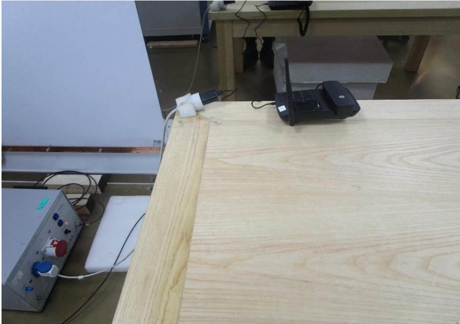
图4 传导连续骚扰试验布置
