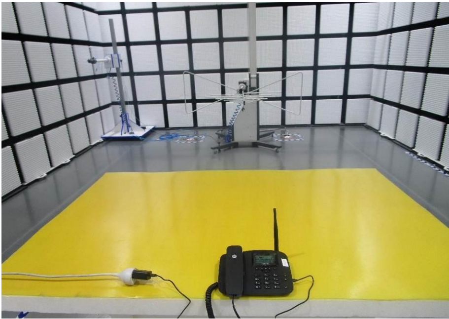
图1 辐射连续骚扰试验布置
