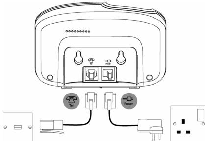
将带有透明连接器的电源适配器插入主机底部标明
