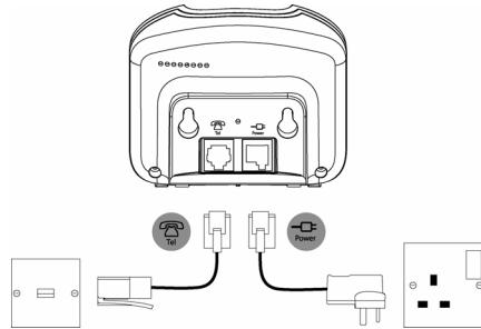
将带有透明连接器的电源适配器插入主机底部标明
