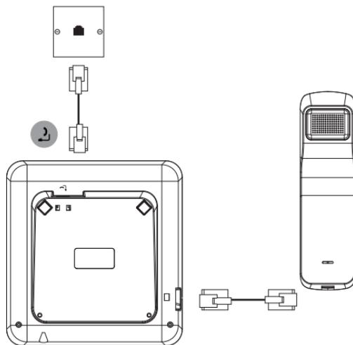
1. 将听筒曲线的一端插入座机侧面的插孔，并将另一端插入听筒底部的插孔。
