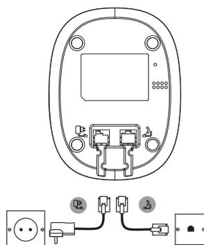
1. 将电话线插入主机底部标有
