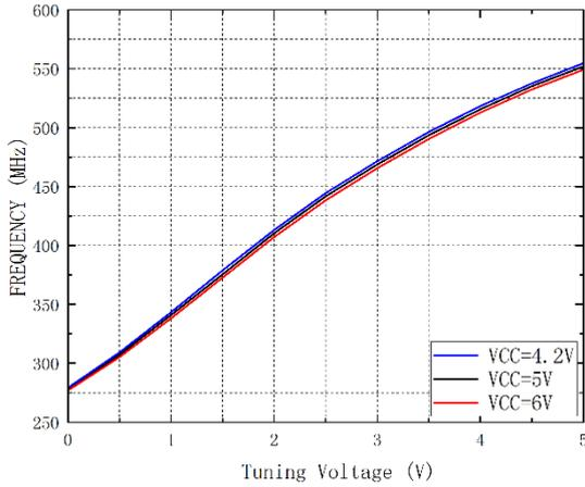
频率 vs. 调谐电压 vs. 温度
