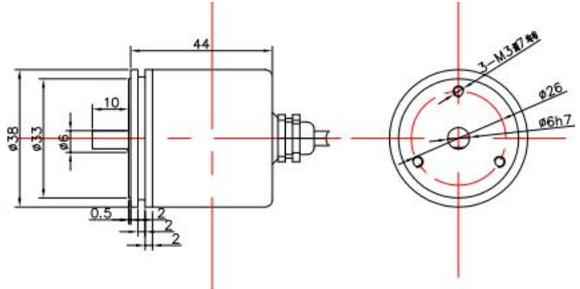
38mm 外径 6mm 轴径 10mm 轴长 径向出线可选
