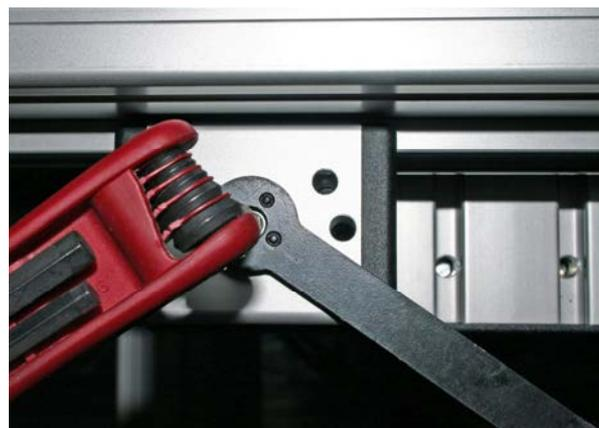
检查皮带紧固螺钉的紧定。若有必要仍要紧固。
