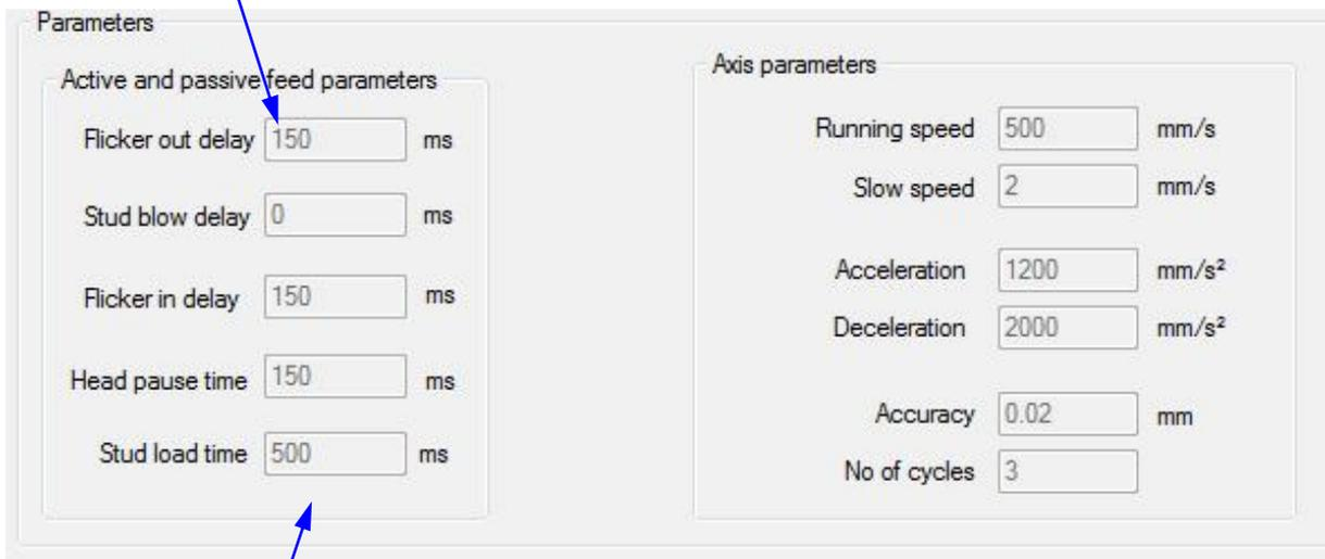
**推杆推出延迟:**在焊枪下降和推杆推出之间产生延迟，如果焊枪要下降2步，则需增加时间。
