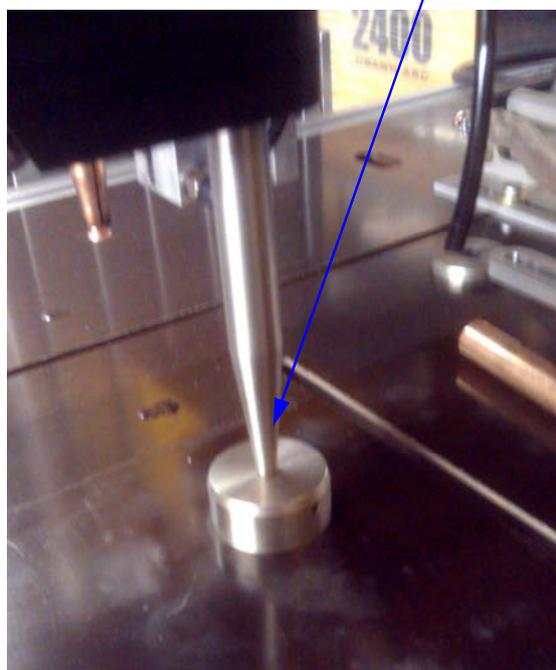
如果焊枪没有遵循之前的说明定位移动到零点位置。（检测是否焊枪1正在测试或焊枪2偏移或其他的情况影响校零）
