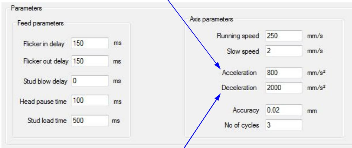
**减速度：**这是在校正移动过程中轴的减速度。加大这个数值将增加定位到某一点的精确度，除了这一点精确度将没有改善。减小这个数值将降低机器的准确度。
