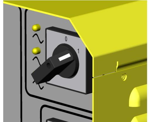
通过电流调节开关完成焊接电流设定。具体设定
