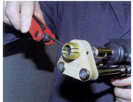
当使用瓷环进行焊接时，应在支脚座上选择安装适合螺栓直径的铜夹箍，拧紧两侧螺母使其固定。
