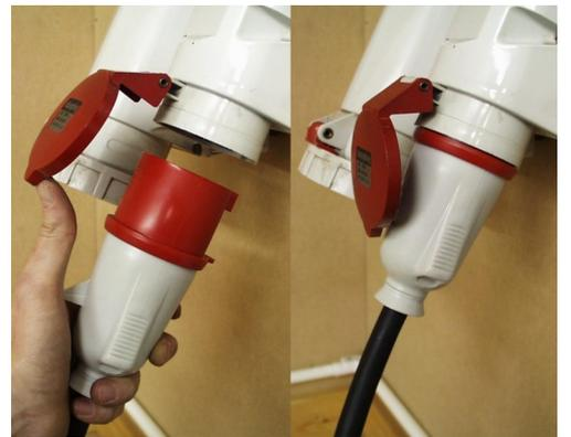
3. 将焊接接地电缆连接在控制器上。注意电缆端插座内有一凹槽与控制器前屏插头上凸端相吻合。
