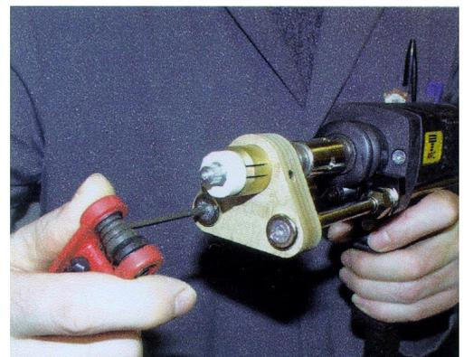
**注意：**如果螺柱靠近支撑脚固定套或瓷环的一侧，会导致焊接失败。
