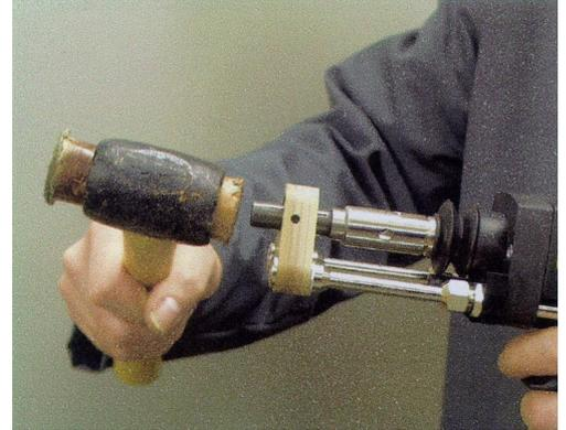
第二步，选择安装适合的支脚。使用瓷环焊接时的标准支脚见图示。（使用气体保护焊接时需更换支脚，参见本说明书的配件图表。）
