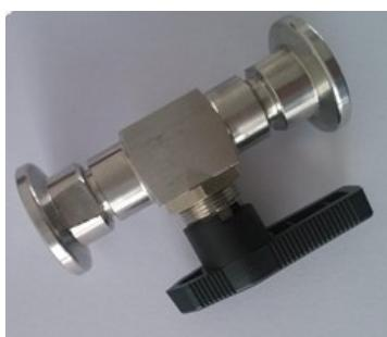
隔离阀—partulab特制的迷你阀，配合手套箱使用。KF16快卸法兰接口，漏率值小于1E-11Pa.m<sup>3</sup>/s,可应用于高真空。
