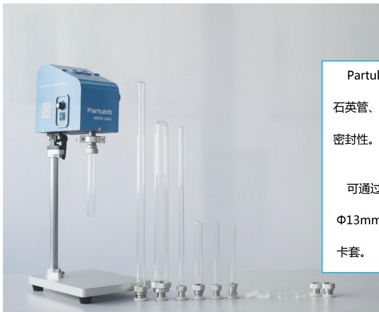
Partulab为客户提供各种规格的标准石英管，管接头、石英管、石英柱达到高精度匹配，有利于实现更好的真空间密封性。
