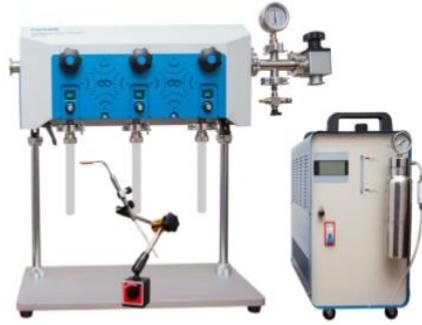
Partulab MRVS-3002 真空封管系统主要用于将样品放入玻璃试管内进行无氧无水真空密封保存，该系统由真空封管系统、氢氧机、真空辅助系统组成，该系统是通过氢氧机产生的火焰将真空密封旋转中的玻璃试管和管内石英柱体热熔压接融合在一起而实现真空密封封接。广泛应用于高校科研院所和企业单位在实验室的日常高纯原料的真空密封、工厂批量进行试管的密封、石英玻璃试管真空密封、硼酸盐玻璃真空密封领域。
