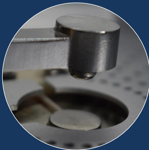
弹簧夹具系统和半球状+平板状电极结构设计，实现更好的测量重复性和稳定性。
