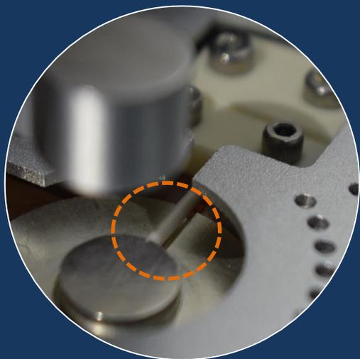
控温和测温采用同一个传感器，保证样品每次采集的温度都是样品实际温度。为进一步模拟样品真实温度，系统可通过已知样品居里温度校准测温传感器。可以避免样品因导热性能不同带来测量的误差。
