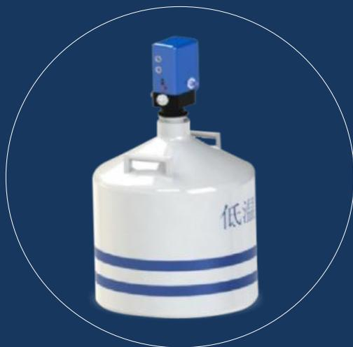
自主研发的低温液氮注入系统，采用加热杜瓦里的液氮气化使杜瓦内的压力增加而将液氮注入制冷平台，通过软件操作，自动补给平台所需制冷量，一次注入液氮可达35L，可完成5-6次实验，是目前介电测量损耗液氮最少的科研仪器。
