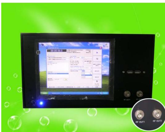
DTV-800一体式数字电视信号源是一款高性能RF信号发生器/数字调频/移动电视信号源。具有强大的码流处理功能，包括码流播放、码流采集、码流刻录，码流通过RF信号或DVB-ASI接口输入，采集并记录到内置存储或分析，MPEG流也可以播放输出到其他广播前端设备使用。
