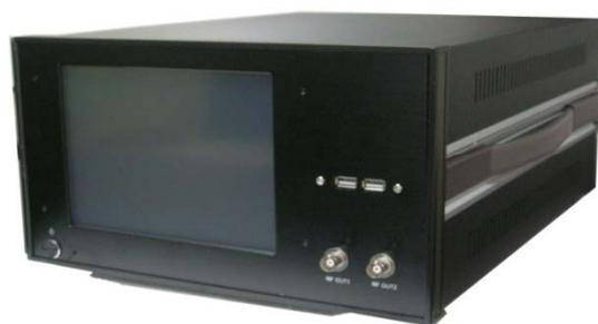
DTV-800 是一款高性能RF信号发生器/数字调频/移动电视信号源，集码流播放、码流采集和信号产生多功能为一体，便携式设计，外观坚固、稳定。其射频范围覆盖VHF, UHF和L段，不仅支持全球数字电视制式，也提供数字电视终端机的研发测试，生产流水线测试，产品品管检验所需的数字信号源。内置的RF电平衰减器和噪波产生功能对灵敏度测试发挥很大作用。
