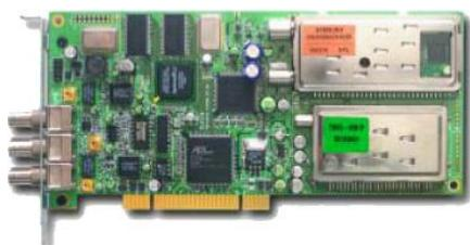
透过DVB-ASI或SMPTE-310M格式输入，MPEG码流播放/采集卡可用于采集并刻录MPEG码流。内置2路8MB缓存以减轻对硬盘速度的要求。能搭配8VSB/QAM接收和DVB-T接收选项。
