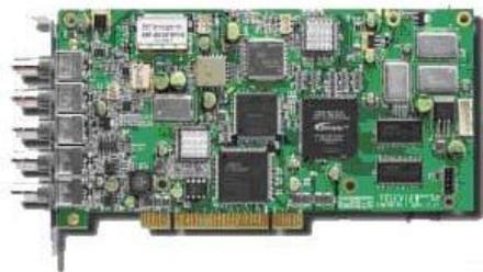
支持全球数字电视和移动电视标准的多功能PCI卡式信号源。功能齐全、操作简单、性价比高。码流来自硬盘经PCI接口或通过ASI端口输入，实时调制后由RF和IF端口输出信号。也具备ASI或SMPTE-310M端口实现MPEG码流播放。强大的播放软件功能：可设置调制参数、可调整电平、提供白噪音和误码率信道干扰机制，定时与定点启动或停止播放等诸多功能。
