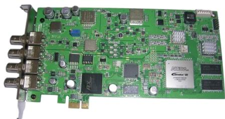
PCI-E卡式信号源与PCI式最大的不同在于接口使用PCI-E,不仅支持全球数字电视和移动电视标准，更符合时下工程机或高端计算机对内部数据高传输速率的要求。功能齐全，操作简单，性价比高。
