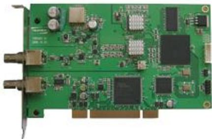
新一代高功效卫星电视信号源，针对卫星电视和L频段信号的高频率环境特殊要求而设计。支持时下通用的DVB-S/S2,ISDB-S标准的新一代数字卫星电视信号源。码流来自硬盘经PCI接口或通过ASI端口输入，实时调制后由RF和IF端口输出信号。增强电平最高能达到+10dBm。强大的播放软件功能：可设置调制参数、可调整电平、提供白噪音和误码率信道干扰机制，定时与定点启动或停止播放等诸多功能。
