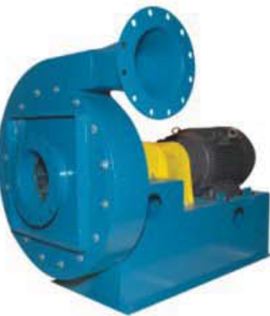
TBNA 涡轮高压鼓风机式离心风机，铝制叶轮 叶轮直径：14.5 至26.5 in. (368 至673 mm) 风量：至5,400 CFM (9,174 m 3 /h) 静压：至57 in. w.g. (14,172 Pa) 样本号：1250
