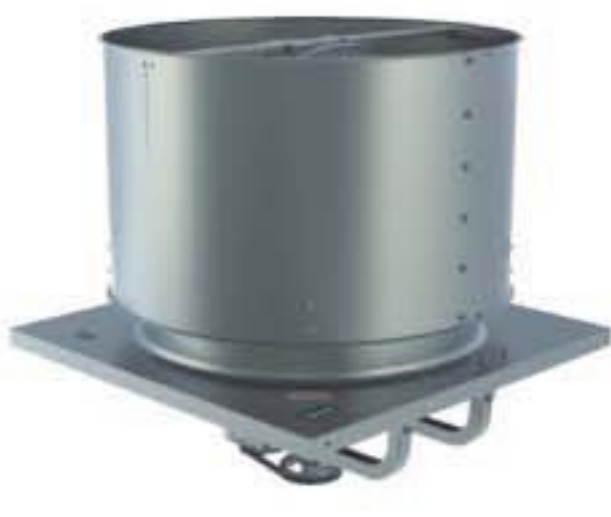
LUB 低矮型上排风螺旋桨式屋顶换气扇，皮带驱动 叶轮直径：21 至 60 in. (533 至 1,524 mm) 风量：至 60,800 CFM (103,299 m 3 /h) 静压：至 1 in. w.g. (248 Pa) UL 705 认证 样本号：4870
