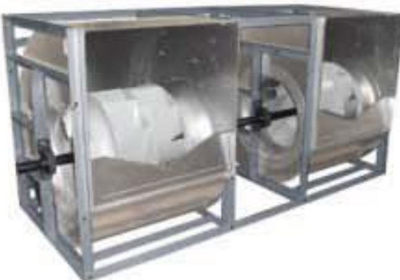
VAF 机翼型非过载离心风机, DWDI 叶轮直径: 11 至40 in. (279 至1,016 mm) 风量: 至85,000 CFM (144,415 m 3 /h) 静压: 至14 in. w.g. (3,480 Pa) 样本号: 5400
