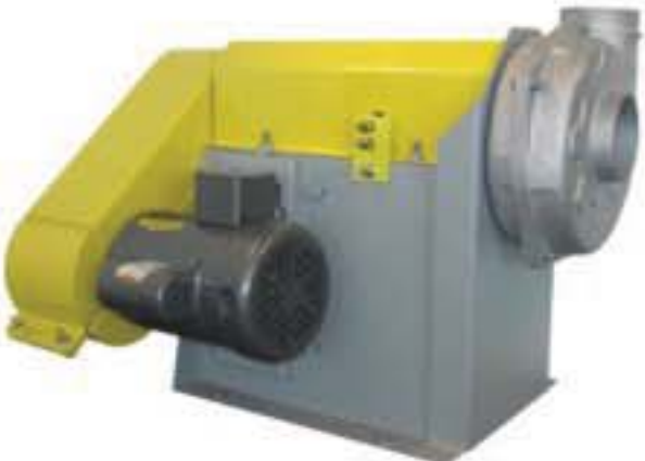
TPB 铸铝高压鼓风机式离心风机，皮带驱动 叶轮直径：8 至18 in. (203 至457 mm) 风量：至2,400 CFM (4,077 m 3 /h) 静压：至22 in. w.g. (5,469 Pa) 样本号：820
