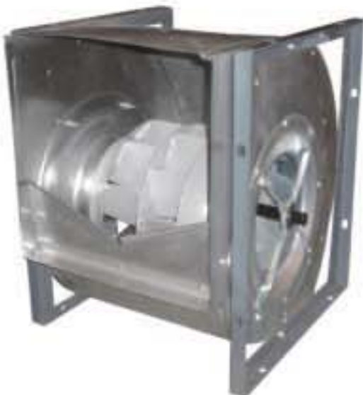
VBC 后倾式非过载离心风机, DWDI 叶轮直径: 10 至40 in. (254 至1,016 mm) 风量: 至85,000 CFM (144,415 m 3 /h) 静压: 至14 in. w.g. (3,480 Pa) AMCA认证的噪声、空气动力性能和能效等级 样本号: 5300
