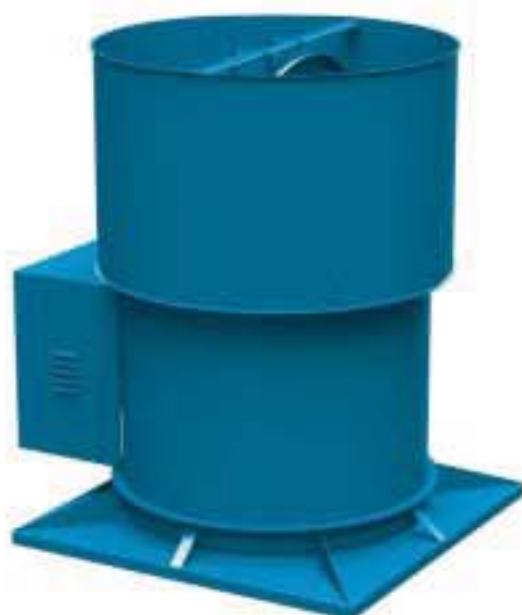
TUB 屋顶上排风管道式轴流换气扇，皮带驱动 叶轮直径：14 至 60 in. (355 至 1,524 mm) 风量：至 72,400 CFM (123,007 m 3 /h) 静压：至 1.5 in. W.g. (372 Pa) AMCA认证的噪声、空气动力性能和能效等级 UL 705 认证 样本号：4850
