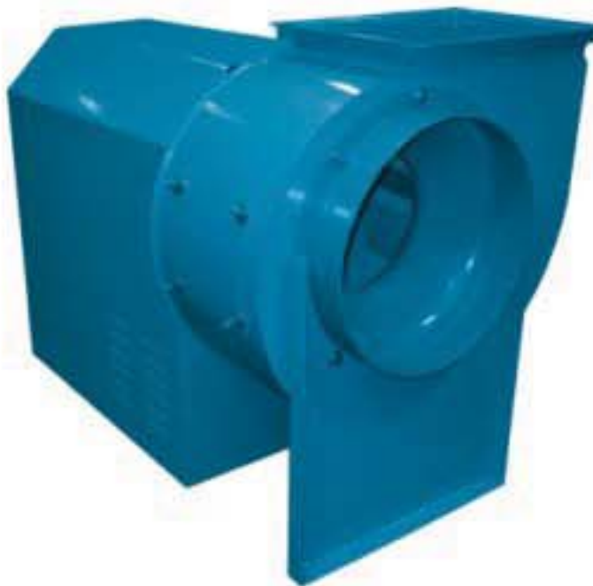
BCVU2 后倾便利式风机 -UL 762 叶轮直径：12.25 至 36.5 in. (311 至 927 mm) 风量：至 29,100 CFM (49,411 m 3 /h) 静压：至 8 in. w.g. (1,989 Pa) AMCA认证的噪声、空气动力性能和能效等级 UL 762 认证可用于含油烟空气 样本号：600
