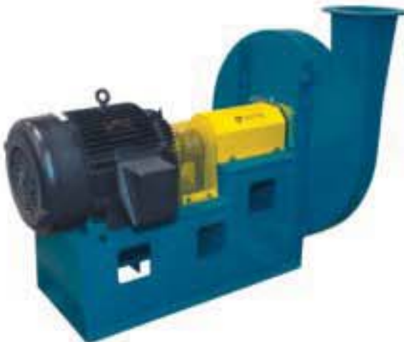
TBR 涡轮高压鼓风机式离心风机，径向叶片叶轮 叶轮直径：10.75 至35.19 in. (273 至893 mm) 风量：至10,100 CFM (17,159 m 3 /h) 静压：至104 in. w.g. (25,857 Pa) 样本号：1200
