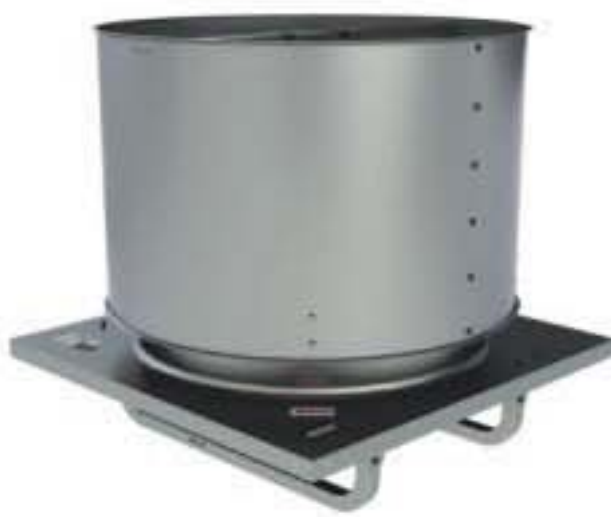
LUD 低矮型上排风螺旋桨式屋顶换气扇，直联驱动 叶轮直径：14 至 48 in. (355 至 1,219 mm) 风量：至 31,400 CFM (53,348 m 3 /h) 静压：至 1 in. w.g. (248 Pa) UL 705 认证 样本号：4870
