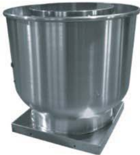
BCRUR 厨房用上排风屋顶离心排风机，皮带驱动 叶轮直径：12.25 至 39.37 in. (311 至 999 mm) 风量：至 17,400 CFM (29,562 m 3 /h) 静压：至 3.25 in. w.g. (808 Pa) AMCA认证的噪声、空气动力性能和能效等级 UL 762 认证可用于含油烟空气 样本号：4105
