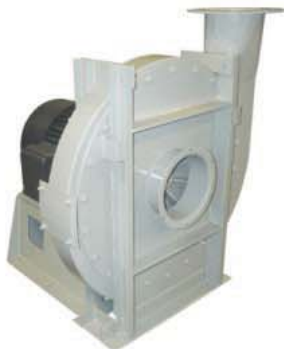
MBW 重载高压鼓风机式离心风机，径向带背板叶轮 叶轮直径：19.63 至58.94 in. (498 至1,497 mm) 风量：至20,000 CFM (33,980 m 3 /h) 静压：至160 in. w.g. (39,781 Pa) 样本号：1400
