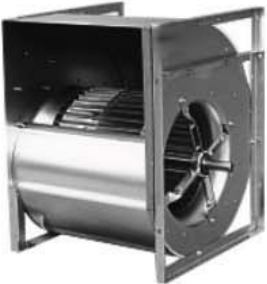
VFC 前弯式离心风机, DWDI 叶轮直径: 6 至40 in. (152 至1,016 mm) 风量: 至110,000 CFM (186,890 m 3 /h) 静压: 至7 in. w.g. (1,740 Pa) AMCA认证的噪声、空气动力性能和能效等级 样本号: 5200
