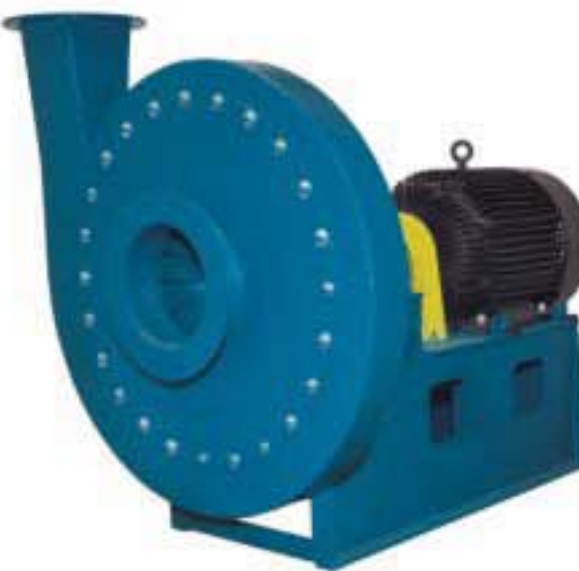
TBA 涡轮高压鼓风机式离心风机，空气处理叶轮 叶轮直径：11.19 至32.06 in. (284 至814 mm) 风量：至28,700 CFM (48,761 m 3 /h) 静压：至70 in. w.g. (17,404 Pa) 样本号：1200
