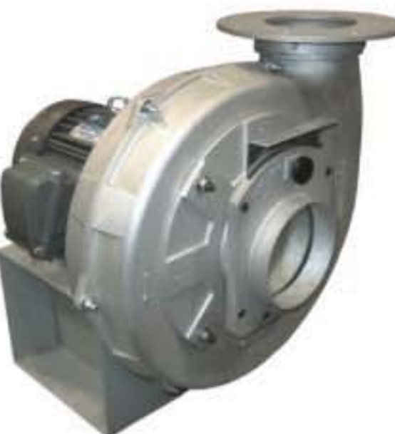
TPD 铸铝高压鼓风机式离心风机，直联驱动 叶轮直径：7 至18 in. (177 至457 mm) 风量：至2,800 CFM (4,757 m 3 /h) 静压：至20 in. w.g. (4,972 Pa) 样本号：820
