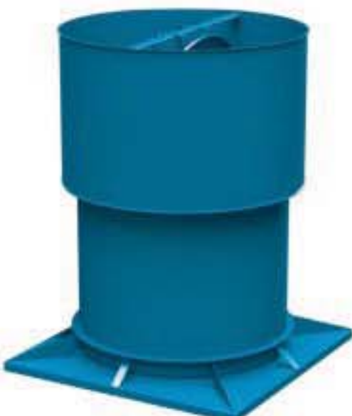
TUD 屋顶上排风管道式轴流换气扇，直联驱动 叶轮直径：14 至 48 in. (355 至 1,219 mm) 风量：至 39,100 CFM (66,430 m 3 /h) 静压：至 1.5 in. w.g. (372 Pa) AMCA认证的噪声、空气动力性能和能效等级 UL 705 认证 样本号：4850
