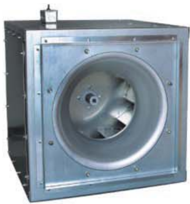
DSI 箱式离心风机, 直联驱动 叶轮直径: 8 至 16.5 in. (203 至419 mm) 风量: 至 5,800 CFM (9,854 m 3 /h) 静压: 至 2 in. w.g. (497 Pa) AMCA认证的噪声、空气动力性能和能效等级 UL 705 认证 样本号: 4205
