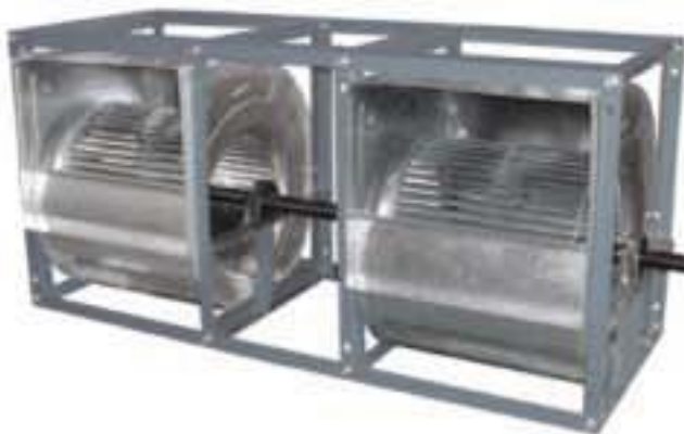
VFC-2 前弯式两台并联风机, DWDI 叶轮直径: 6 至40 in. (152 至1,016 mm) 风量: 至110,000 CFM (186,890 m 3 /h) 静压: 至8 in. w.g. (1,989 Pa) 样本号: 5200
