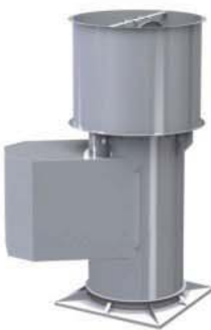
UBDF / UBDFQ / UBDFX / UBDFZ 上排风PRV风机(管道式风机) 叶轮直径：12 至 72 in. (304 至 1,828 mm) 风量：至 75,000 CFM (127,425 m 3 /h) 静压：至 1.5 in. w.g. (372 Pa) 样本号：AX010
