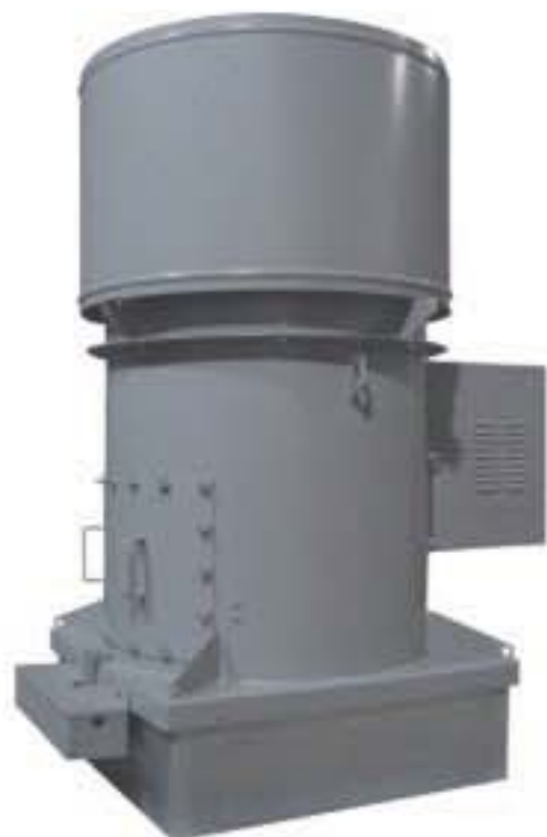
TCLBR 餐厅用管道离心风机，皮带驱动 叶轮直径：10.5 至 49 in. (266 至 1,245 mm) 风量：至 41,700 CFM (70,848 m 3 /h) 静压：至 4 in. w.g. (994 Pa) AMCA认证的噪声、空气动力性能和能效等级 UL 762 认证可用于含油烟空气 样本号：4215
