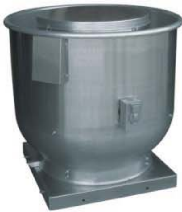
DCRUR 厨房用上排风屋顶离心排风机，直联驱动 叶轮直径：8.38 至 18.25 in. (212 至 463 mm) 风量：至 3,865 CFM (6,566 m 3 /h) 静压：至 1.5 in. w.g. (372 Pa) AMCA认证的噪声、空气动力性能和能效等级 UL 762 认证可用于含油烟空气 样本号：4105
