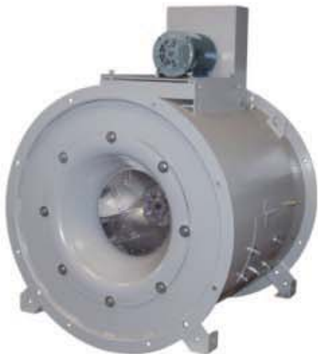
TCLB 管道离心风机, 皮带驱动 叶轮直径: 10.5 至 49 in. (266 至1,245 mm) 风量: 至41,700 CFM (70,848 m 3 /h) 静压: 至4 in. w.g. (995 Pa) AMCA认证的噪声、空气动力性能和能效等级 UL 705 认证 样本号: 4215
