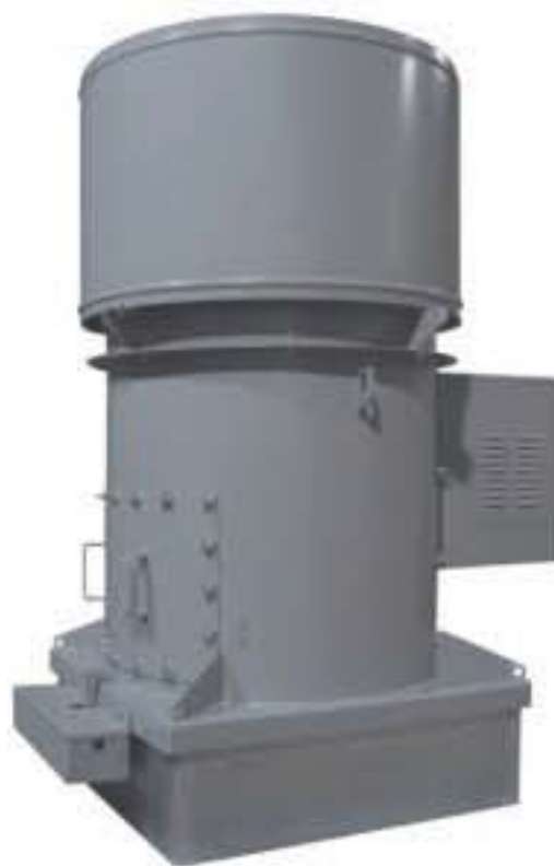
TCLBR 管道离心风机, 厨房专用, 皮带驱动 叶轮直径: 10.5 至 49 in. (266 至1,245 mm) 风量: 至41,700 CFM (70,848 m 3 /h) 静压: 至4 in. w.g. (995 Pa) AMCA认证的噪声、空气动力性能和能效等级 UL 762认证用于排含油烟空气 样本号: 4215
