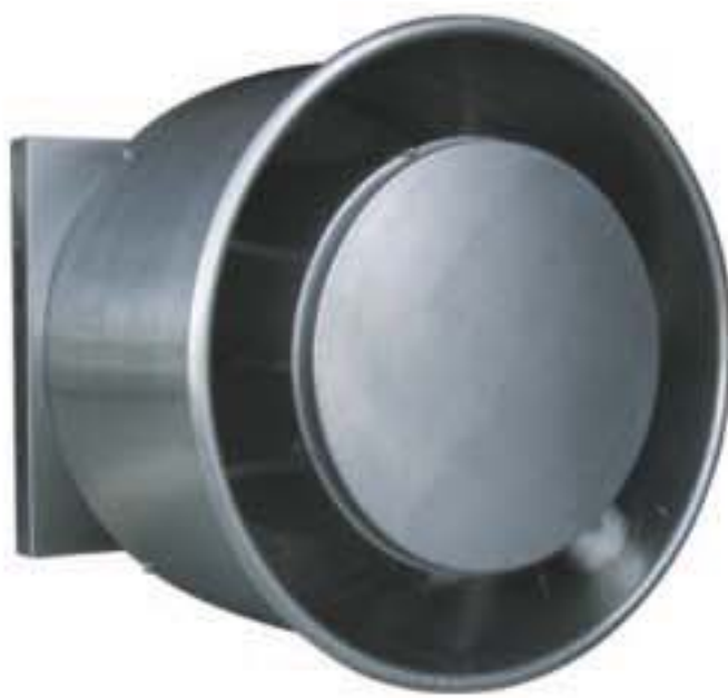
DCRWR 厨房用边墙离心排风机，直联驱动 叶轮直径：8.38 至 18.25 in. (212 至 463 mm) 风量：至 3,865 CFM (6,566 m 3 /h) 静压：至 1.5 in. w.g. (372 Pa) AMCA认证的噪声、空气动力性能和能效等级 UL 762 认证可用于含油烟空气 样本号：4105
