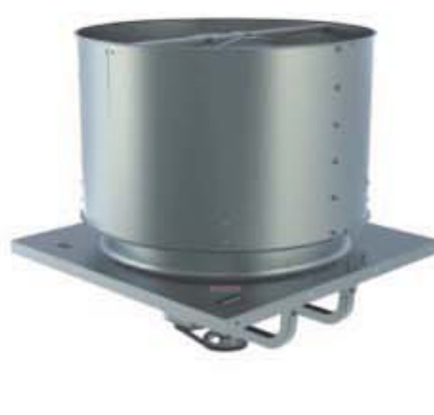
LUBSH 低矮型排烟散热屋顶换气扇 叶轮直径：21 至 60 in. (533 至 1,524 mm) 风量：至 60,800 CFM (103,299 m 3 /h) 静压：至 1 in. w.g. (248 Pa) UL 认证用于烟气控制系统 样本号：4870
