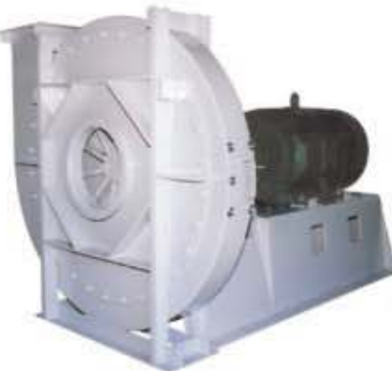
MBO 重载高压鼓风机式离心风机，开放式叶轮 叶轮直径：19.63 至58.94 in. (498 至1,497 mm) 风量：至18,000 CFM (30,582 m 3 /h) 静压：至170 in. w.g. (42,267 Pa) 样本号：1400
