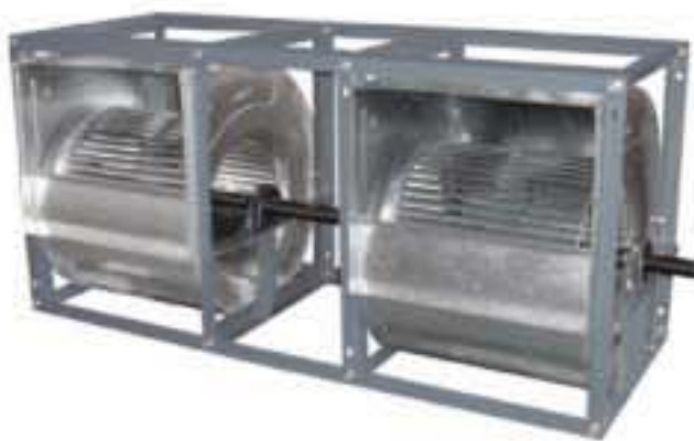
TFC-2 前弯式两台并联风机, DWDI 叶轮直径: 7 至30 in. (177 至762 mm) 风量: 至52,000 CFM (88,348 m 3 /h) 静压: 至5.5 in. w.g. (1,367 Pa) 样本号: 5100
