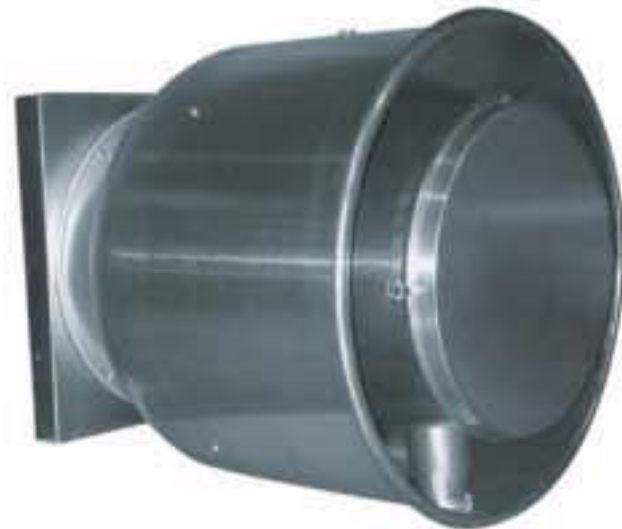
BCRWR 厨房用边墙离心排风机，皮带驱动 叶轮直径：12.25 至 31.5 in. (311 至 800 mm) 风量：至 11,600 CFM (19,708 m 3 /h) 静压：至 3.25 in. w.g. (808 Pa) AMCA认证的噪声、空气动力性能和能效等级 UL 762 认证可用于含油烟空气 样本号：4105
