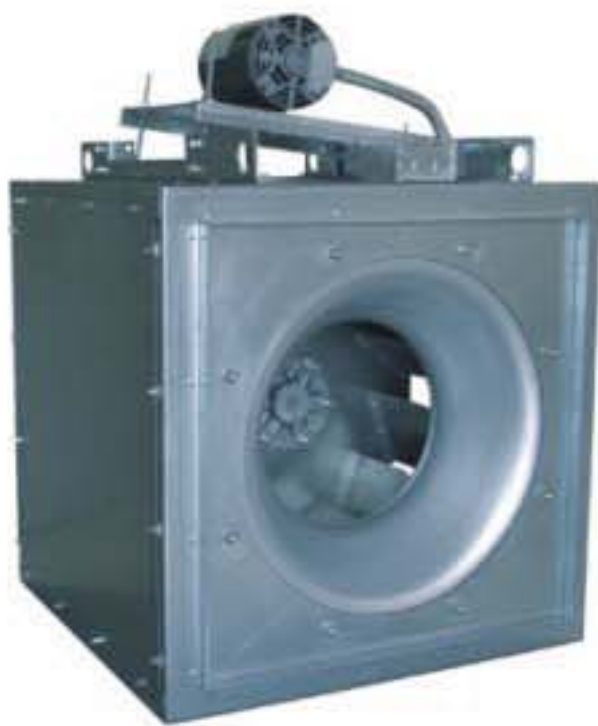
BSI 箱式离心风机, 皮带驱动 叶轮直径: 8 至 40 in. (203 至1,016 mm) 风量: 至 27,400 CFM (46,553 m 3 /h) 静压: 至 3.5 in. W.g. (870 Pa) AMCA认证的噪声、空气动力性能和能效等级 UL 705 认证 样本号: 4205
