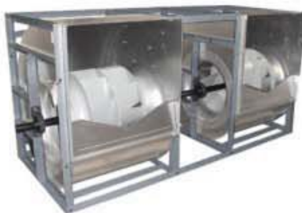
VBC-2 后倾式两台并联风机, DWDI 叶轮直径: 10 至40 in. (254 至1,016 mm) 风量: 至85,000 CFM (144,415 m 3 /h) 静压: 至14 in. w.g. (3,480 Pa) 样本号: 5300
