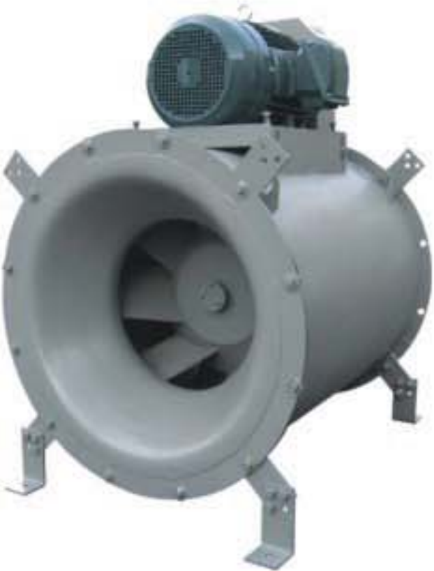
QCLBR 餐厅用低压混流风机 叶轮直径：12.25 至 73 in. (311 至 1,854 mm) 风量：至 105,000 CFM (178,395 m 3 /h) 静压：至 4.5 in. w.g. (1,119 Pa) AMCA认证的噪声、空气动力性能和能效等级 UL 762 认证可用于含油烟空气 样本号：1070
