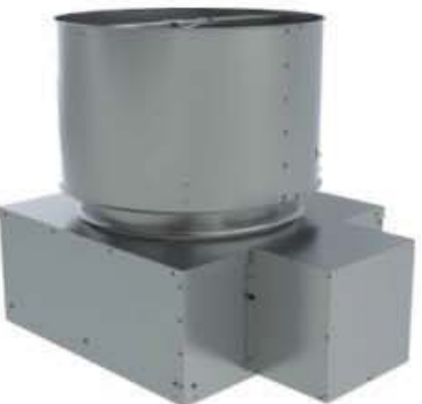
LUBMO 低矮型螺旋桨式屋顶换气扇，电机外置 叶轮直径：21 至 60 in. (533 至 1,524 mm) 风量：至 60,800 CFM (103,299 m 3 /h) 静压：至 1 in. w.g. (248 Pa) UL 705 认证 样本号：4870
