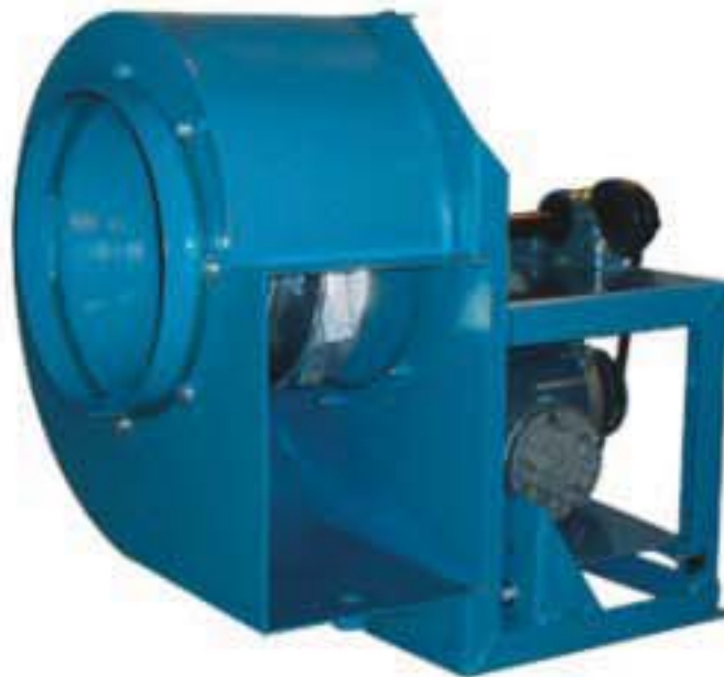
BCJU2 后倾小型便利式风机-UL 762 叶轮直径：9 至 10.5 in. (228 至 266 mm) 风量：至 1,900 CFM (3,228 m 3 /h) 静压：至 5 in. w.g. (1,243 Pa) AMCA认证的噪声、空气动力性能和能效等级 UL 762 认证可用于含油烟空气 样本号：551
