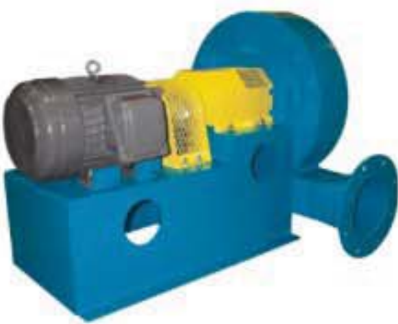
TBNS 涡轮高压鼓风机式离心风机，钢制叶轮 叶轮直径：14.5 至26.5 in. (368 至673 mm) 风量：至5,400 CFM (9,174 m 3 /h) 静压：至57 in. w.g. (14,172 Pa) 样本号：1250
