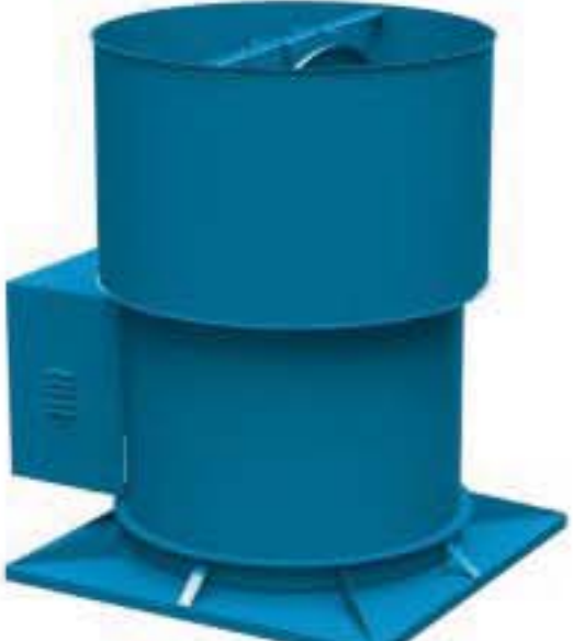
TUBSH 排烟散热屋顶换气扇，皮带驱动 叶轮直径：24 至 60 in. (609 至 1,524 mm) 风量：至 70,700 CFM (120,119 m 3 /h) 静压：至 1.5 in. w.g. (372 Pa) AMCA认证的噪声、空气动力性能和能效等级 UL 认证用于烟气控制系统 样本号：4850
