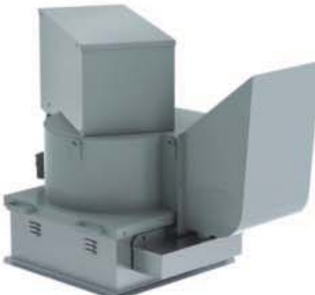
BHRE 餐厅用铰链安装离心排风机，皮带驱动 叶轮直径：10.5 至 24.5 in. (266 至 622 mm) 风量：至 9,043 CFM (15,364 m 3 /h) 静压：至 5 in. w.g. (1,245 Pa) AMCA认证的噪声、空气动力性能和能效等级 UL 762 认证可用于含油烟空气 样本号：610
