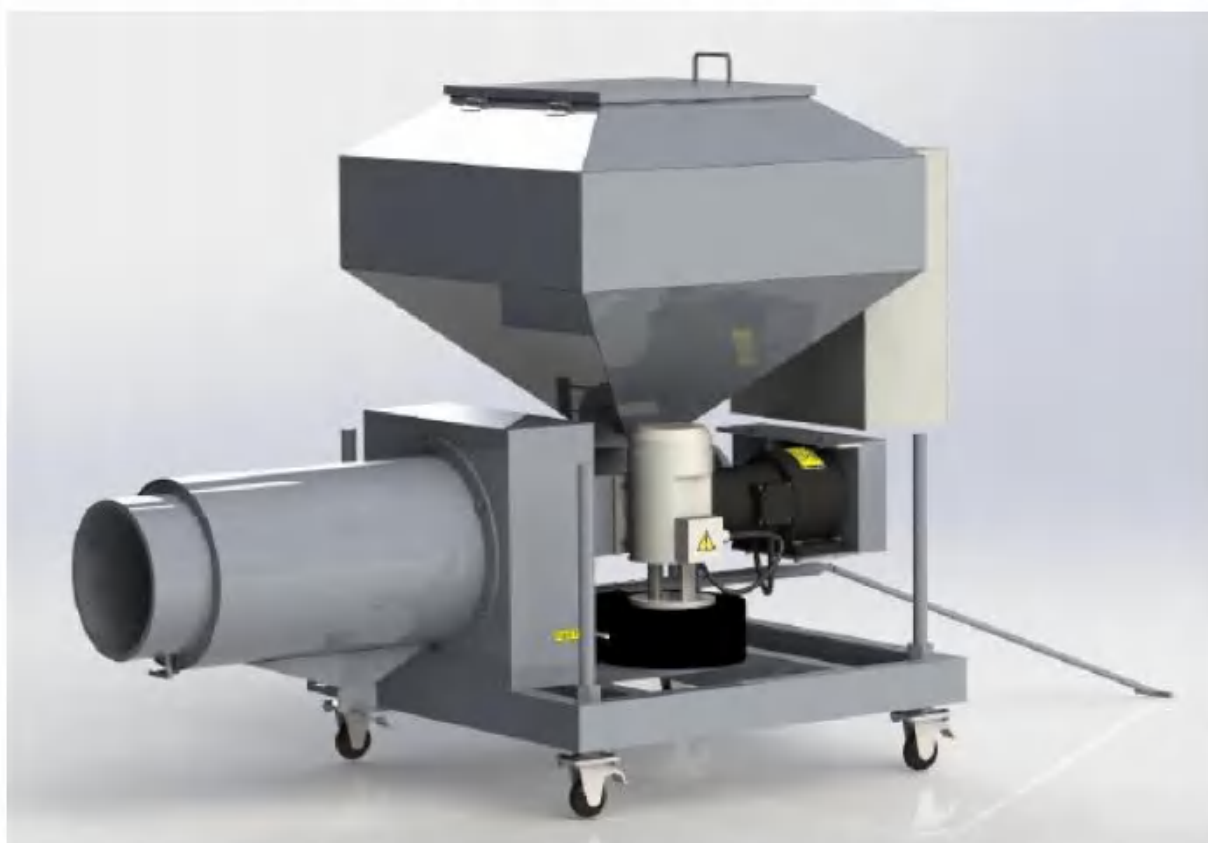
图 3.5-2 烘干设施燃烧机实物图
