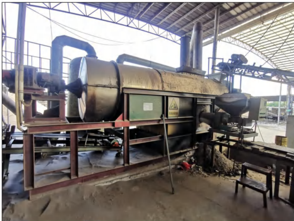
图 3.5-3 燃烧机与烘干炉实物连接图
