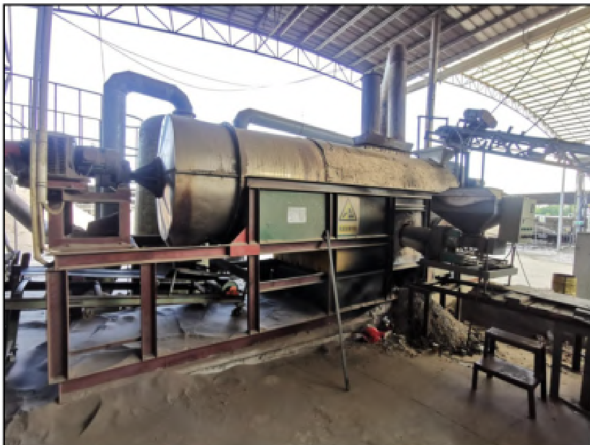
图 3.5-3 燃烧机与烘干炉实物连接图
