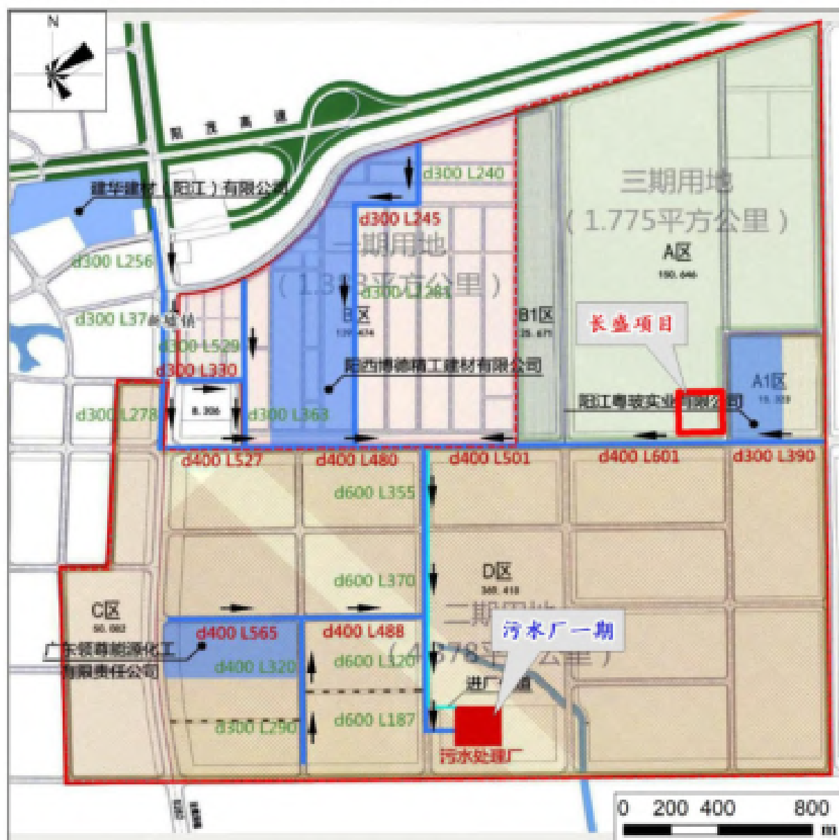
图 6.2-5 阳西县新墟产业园污水管网图
