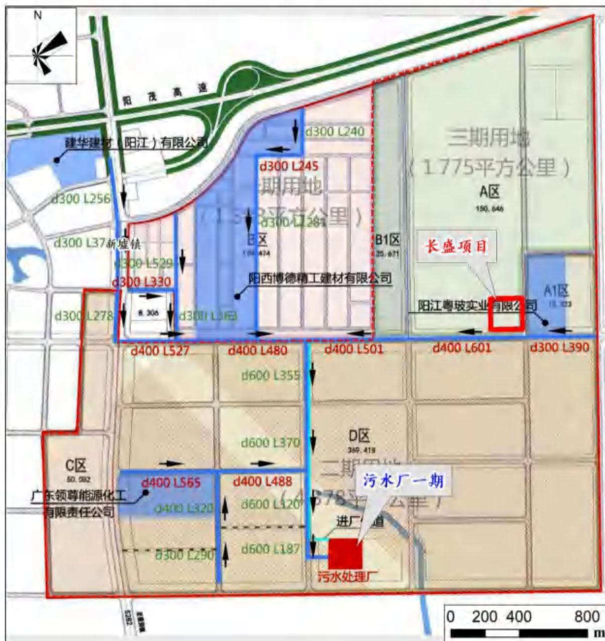
图 6.2-4 阳西产业新墟片区污水管网图
