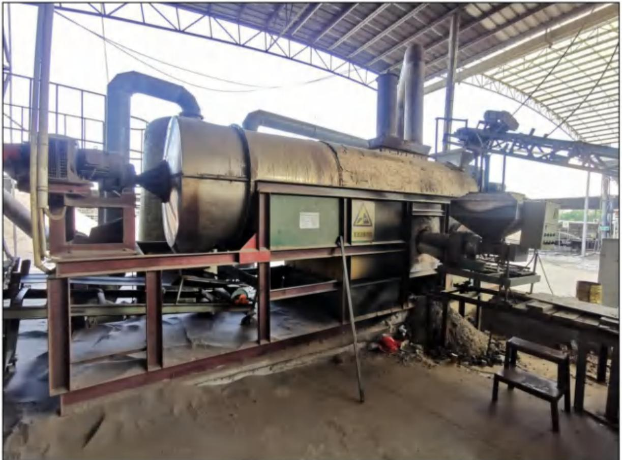
图 3.5-3 燃烧机与烘干炉实物连接图
