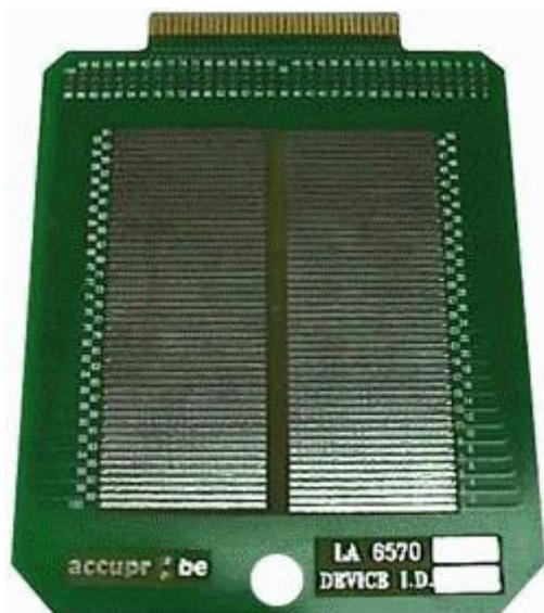
LA 系列探针卡除了印刷板接插件有 48、70 或 100 引出脚的不同外，它们本质上都是相同的，每个探针卡上有 100 个探针固定位，可以把迹线连接到转接布线区域。通过从转接布线区域到印刷板接插件的简单跳线来完成连接。每个探针卡尺寸为 6.5×8.0 英寸。孔洞尺寸在 Y 轴=N/S 内是固定值 5.0 英寸，在 X 轴=E/W 内的最大孔洞尺寸为 3.5 英寸，下单请注明型号 LA65###T2X17（###=印刷板接插件，X=E/W
