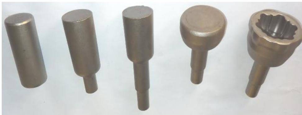
图 4-6 钟形壳 5 工位温锻的制品
