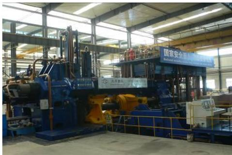
图 4-4 100MN“短行程”双动卧式铝挤压机
