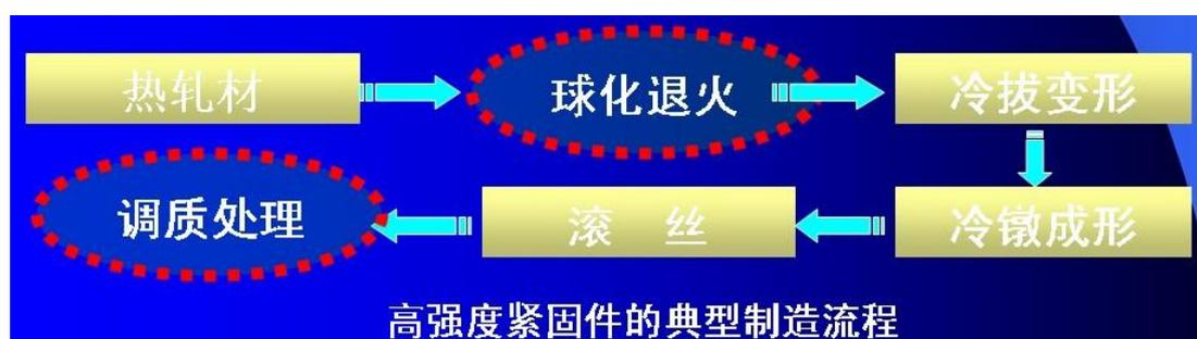
图 4-17 高强度紧固件的典型制造流程
