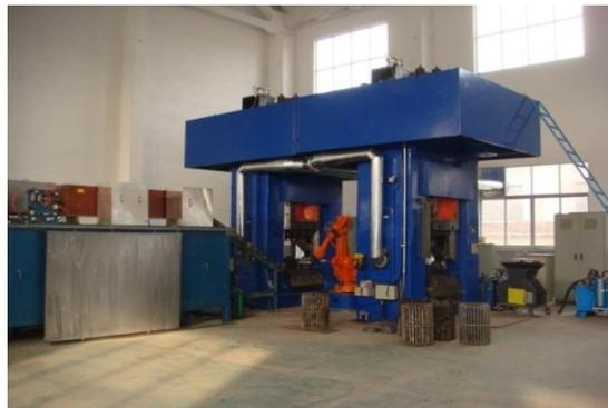
图 4-11 一台机器人方式锻造自动生产线
