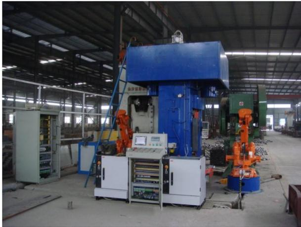
图 4-12 二台机器人方式锻造自动生产线
