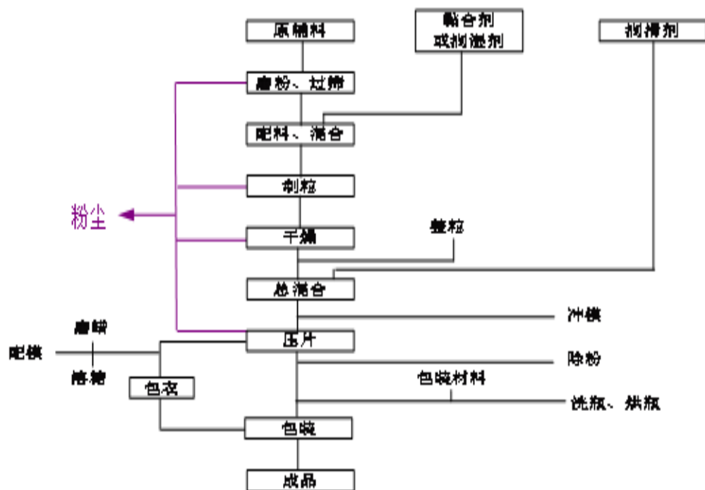
图 4.28 片剂生产工艺流程和排污节点图
