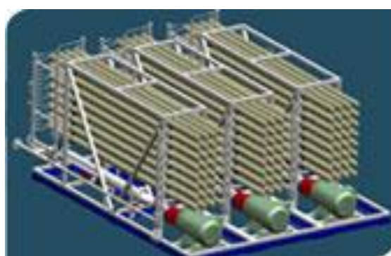
图 4.7 连续式纳滤系统
