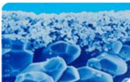
图 4.4 无机陶瓷膜电子扫描剖面图
