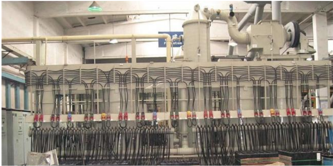
图 6.6 酸电解液循环电池化成系统
