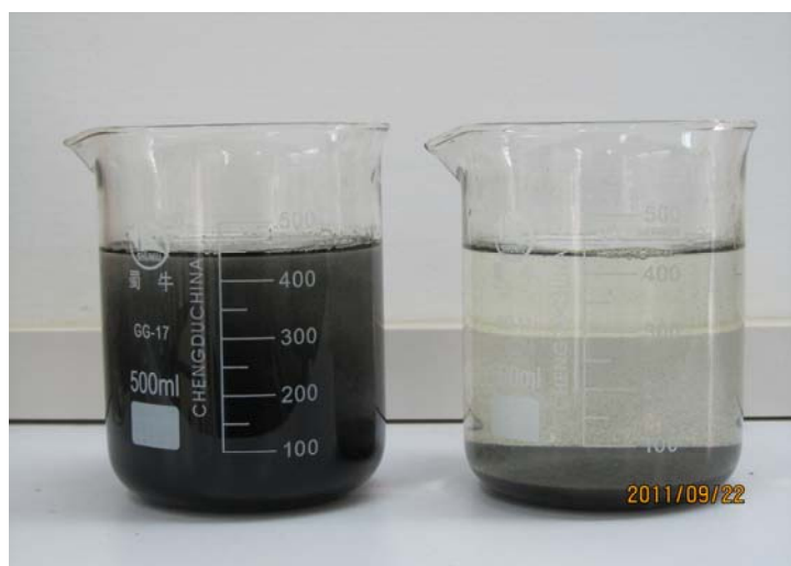
图 4.3.5.7 印染废水 A 处理前后对比
