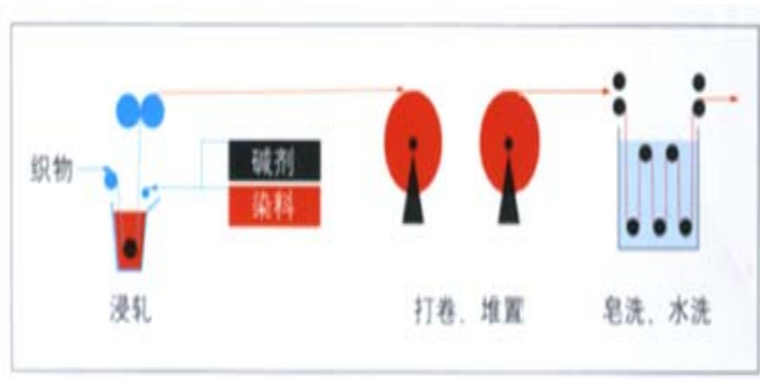
图 4.1.5.1 冷轧堆染色工艺流程
