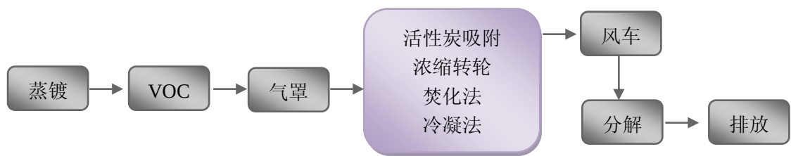
图 5-14 太阳能电池片生产过程中 VOC 废气处理技术
