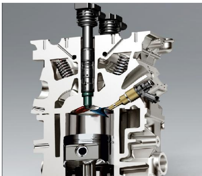
图 2 缸内汽油直喷发动机设备原理图
